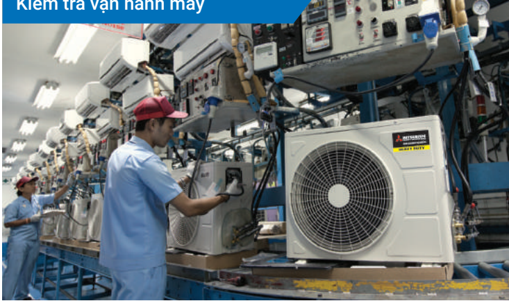
Kiểm tra vận hành máy
